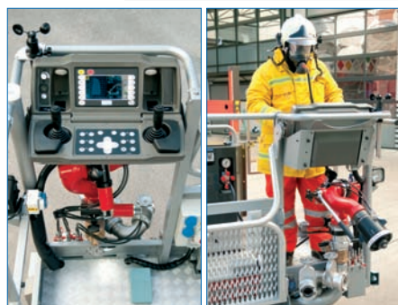
Sve F 32 TLK jedinice imaju integriran Bronto+ sistem. Kontrolni centri imaju ekrane u boji sa izvrsnom vidljivošću.
