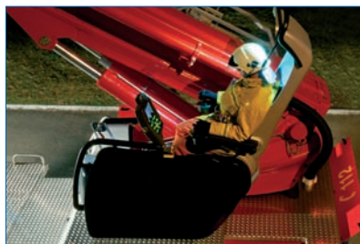
Novi upravljački centar kod okretnog dijela sa ergonomski dizajniranim sjedalom i ručicama za upravljanje kos naslonjača za ruke.
