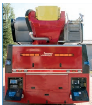
Kontrole za upravljanje potpornim cilindrima sa obje strane – prema DIN-u.
